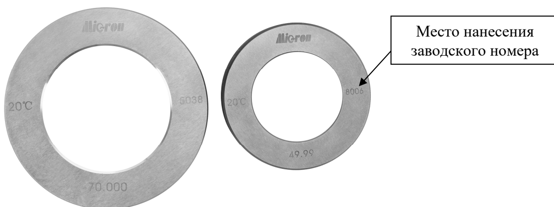
Рисунок 2 – Общий вид колец с указанием места нанесения заводского номера
